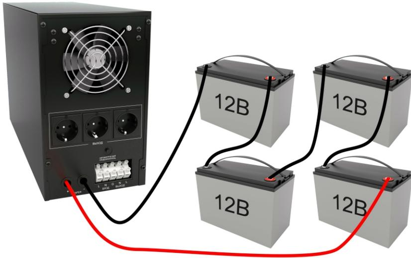
Схема подсоединения аккумуляторной батареи – 12 В
