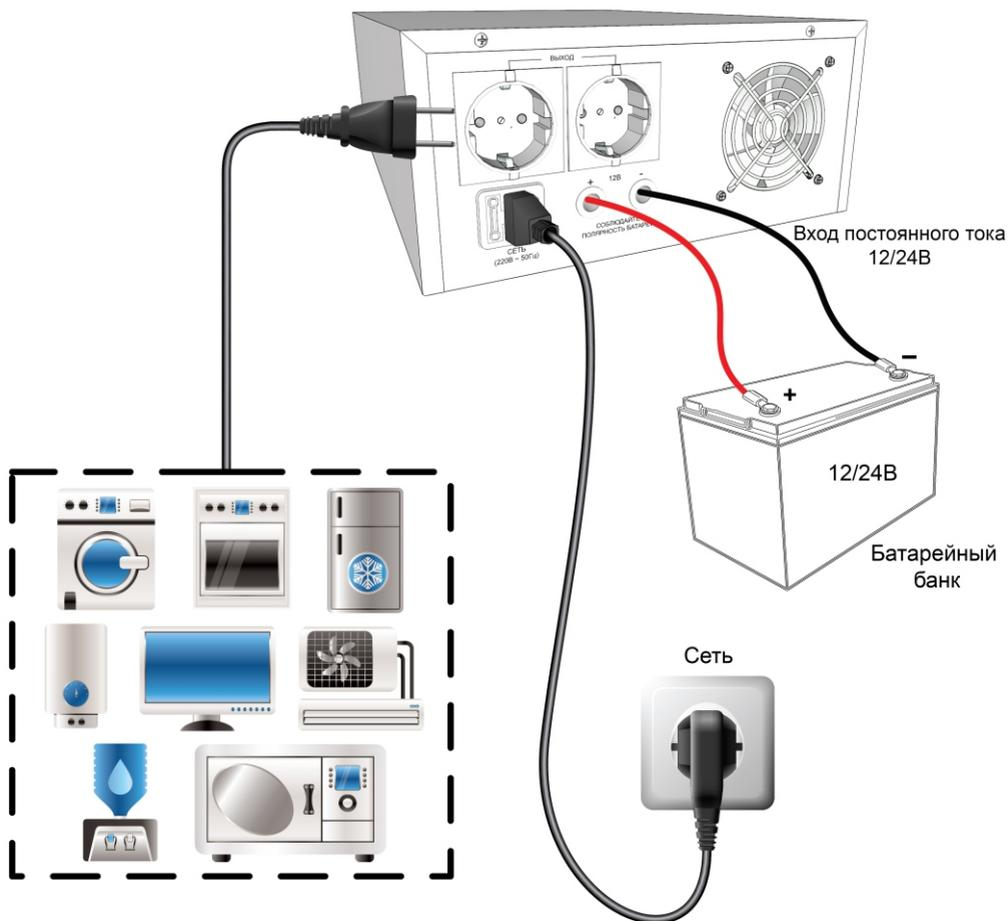
Основная схема подключения ИБП серии LUX (600-1000Вт)
