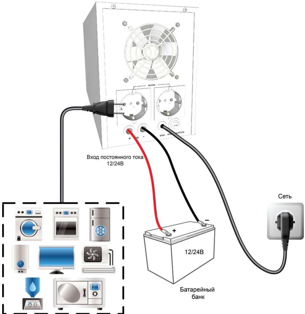
Основная схема подключения ИБП серии LUX (1200-4000Вт)
