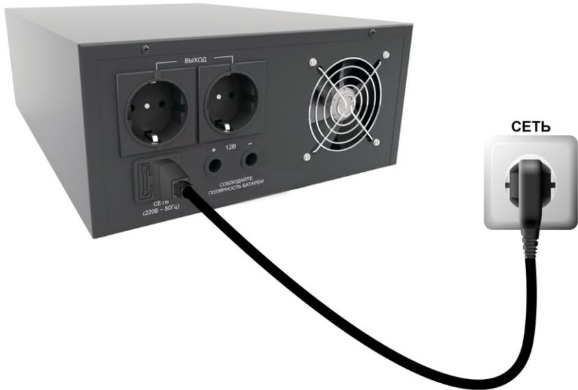
Схема подключения вилки нагрузки к выходу прибора
